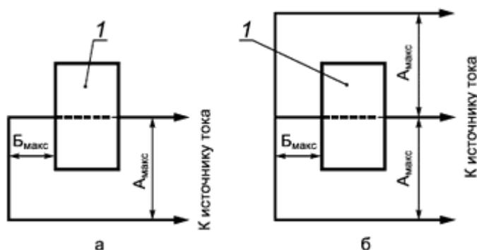
1 - испытываемый трансформатор;  $A_{\text{макс}}$  - расстояние между осями проводников соседних фаз в месте установки трансформатора в эксплуатации;  $B_{\text{макс}}$  - расстояние в свету от трансформатора до места ближайшего изгиба проводника, служащего в эксплуатации первичной обмоткой трансформатора
